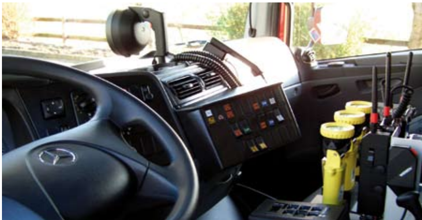
Die Anordnung der Sondersignalanlage war durch die Feuerwehr vorgegeben. (Foto: L.v.d. Hoogen)
